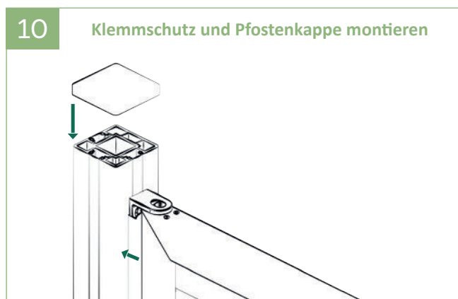
10 | Klemmschutz montieren, hierzu das Profil auf die Torbänder clippen. Zum Schluss die Kappe montieren.
