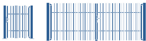
Portail battant 1 vantail Portail battant 2 vantaux symétriques (pour les passages de 2m et 4m)
